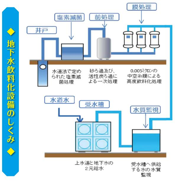
地下水飲料化設備能力としては、1日に360m³の飲料水を送り出す事ができ、当院で使用している約300m³分を地下水で賄う能力を有します。また、停電時にも設備を稼働させることができるよう、専用の非常用発電機も備えています。
